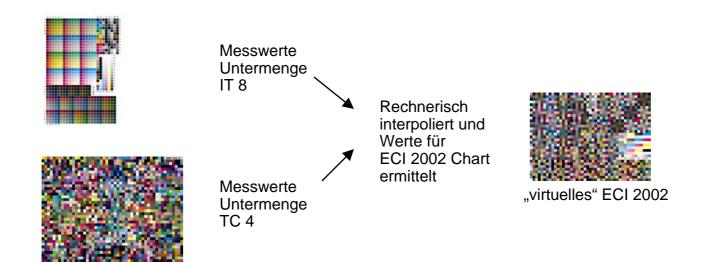
Rechnerische Erzeugung von Charakterisierungsdaten des Druckes
